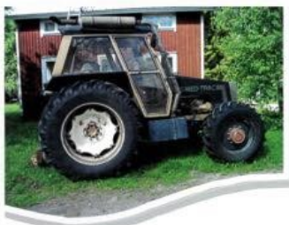
Swed-trac med 8 liters Scania motor från 1986 Tillverkad i Arvika av tre bondpojkar! En kraftfull traktor på sin tid.
