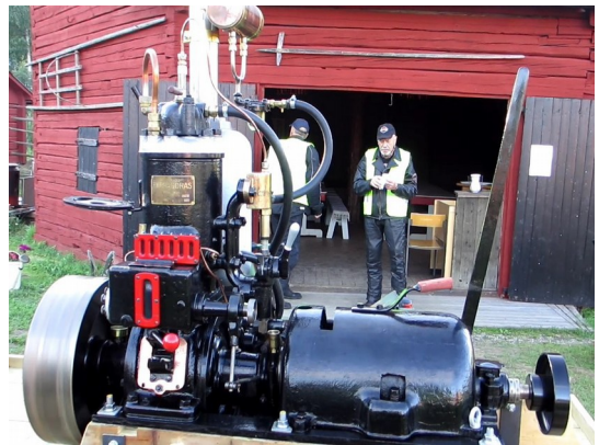
Demo av Tändkulemotor från 1924.
